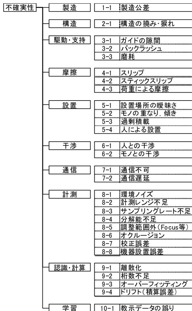
図 3.8 家庭内物流支援ロボットシステムにおける不確実性の構造分類化
