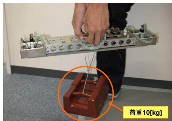
図 3.82 荷重支持性能確認試験の様子
