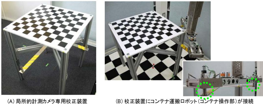
(A) 局所的計測カメラ専用校正装置
