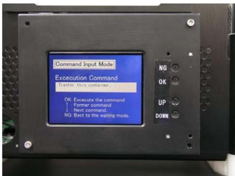
図 3.23 液晶表示デバイスと UI 用スイッチ
