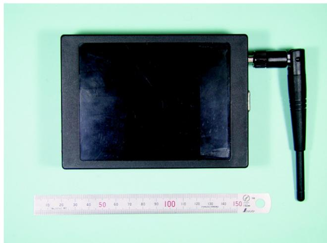
図 4.18: デスクトップ設置型シリアル無線機
