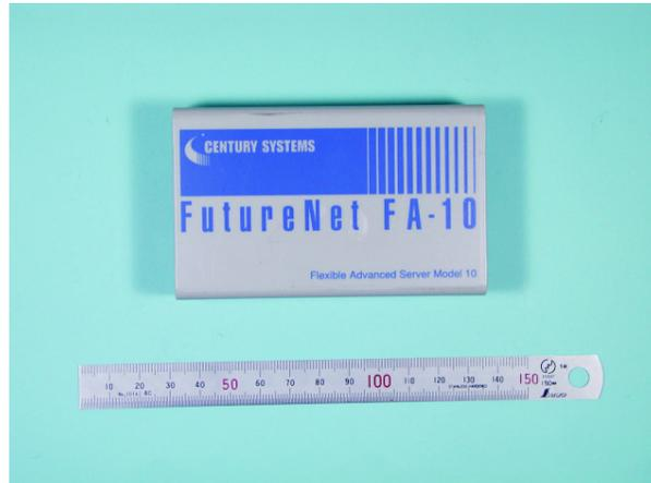
図 4.19: (Ethernet-Serial) 変換器
