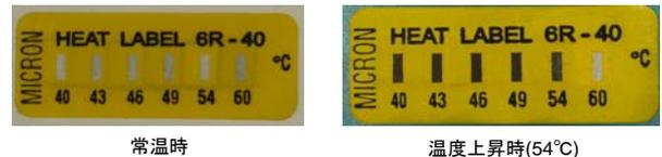
Fig. 4: 温度表示用ステッカー "ヒート・ラベル"
